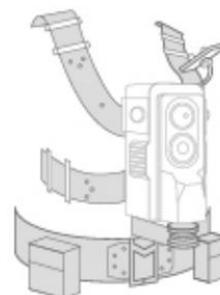
2. 用手平稳拿起相机后，将相机放置背心卡扣处，确保相机已对准背心卡扣位置后，在背心卡扣底部往内扭动卡扣，直至扭紧。
